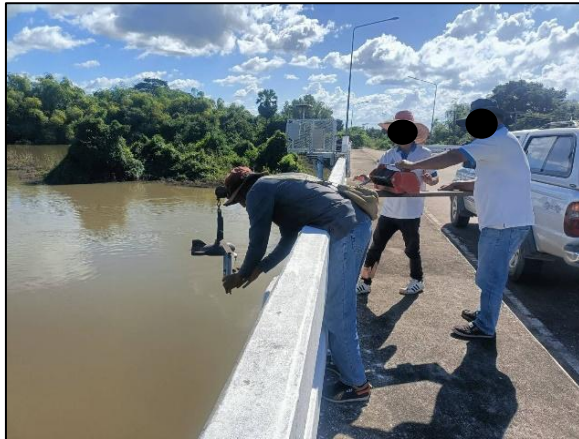
รูปที่ 5.2.6-2 การเก็บตัวอย่างตะกอนของสถานี Y.50 บริเวณด้านเหนือโครงการประตูประบายน้ำ ท่านางงาม
