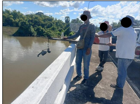
รูปที่ 5.2.6-2 การเก็บตัวอย่างตะกอนของสถานี Y.50 บริเวณด้านเหนือโครงการประตูประบายน้ำ ท่านางงาม
